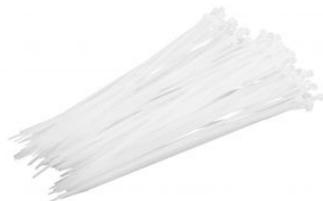
Хомуты для крепления электропроводки изготовлены из чистого 6/6 Nylon. Хомуты обладают самоконтрящимся замком. Для больших диаметров необходимо соединить два или более хомутов. Хомуты используются при температуре от -40 °С до +80 °С. Обеспечивают быстрое и надёжное соединение.
