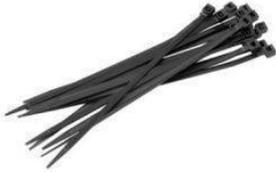
Хомуты для крепления электропроводки изготовлены из чистого 6/6 Nylon. Хомуты обладают самоконтрящимся замком. Для больших диаметров необходимо соединить два или более хомутов. Хомуты используются при температуре от -40 °C до 80 °C. Обеспечивают быстрое и надёжное соединение.
